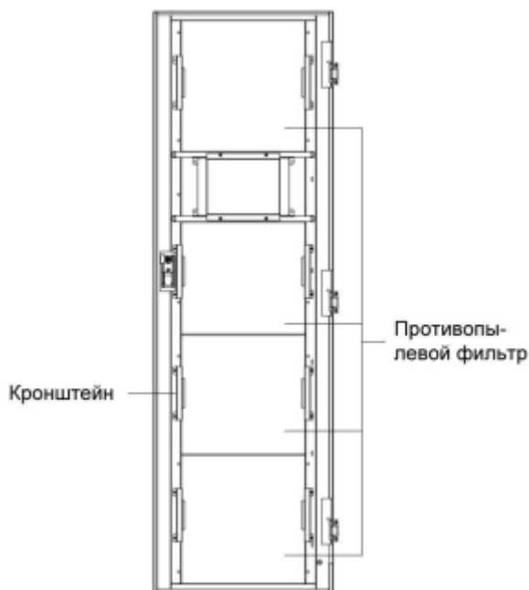
Рис. 6-1. Противопоyleвой фильтр на тыльной стороне передней дверцы ИБП
