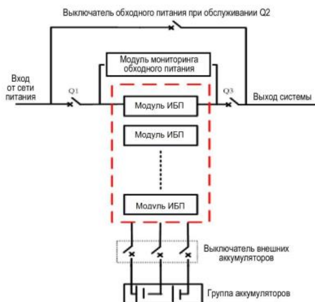
Рис. 2-1. Функциональная схема ИБП
