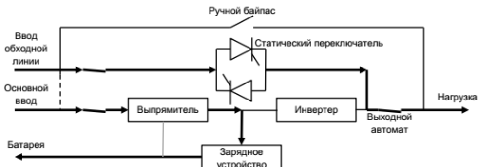
Рис. 1-4 Режим обходной линии
